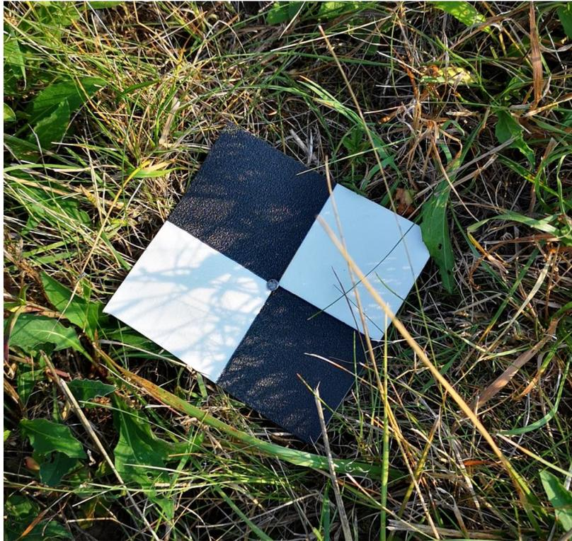
Abbildung 2.13: Selbstgebauter GCP
