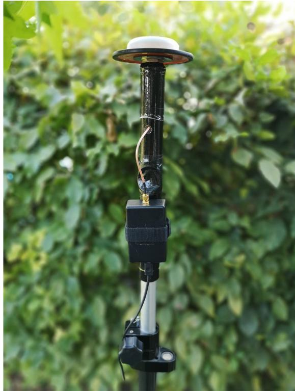
Abbildung 2.8: GNSS-Antennenstab mit Receiver und Libelle
