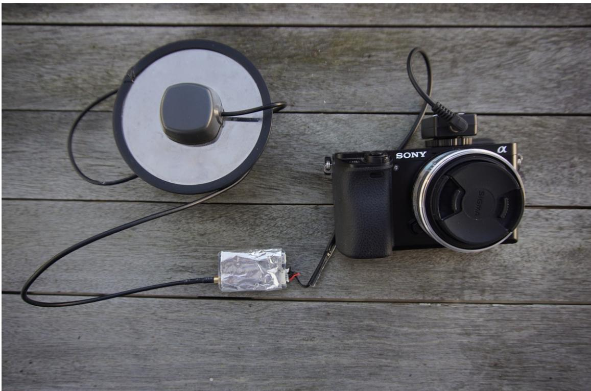
Abbildung 2.6: Abgeschirmtes Reach RTK-Modul mit Kamera und Antenne
