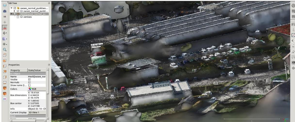
**Abbildung 23: Punktwolke und 3D-Modell von U2S aus VisualSFM in CloudCompare**
