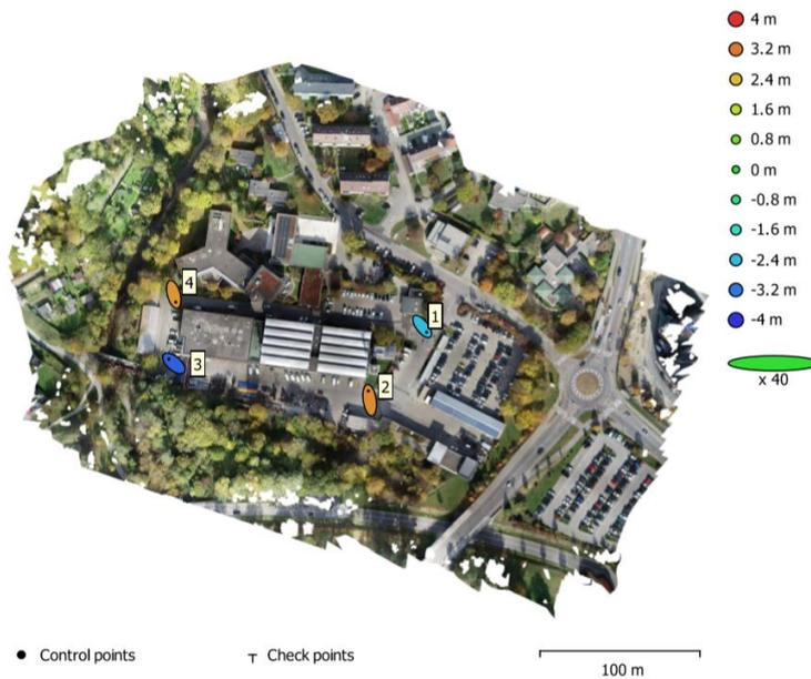
Abbildung 31: GCP-Lage und Fehlerschätzung bei Agisoft Metashape (U2O)
