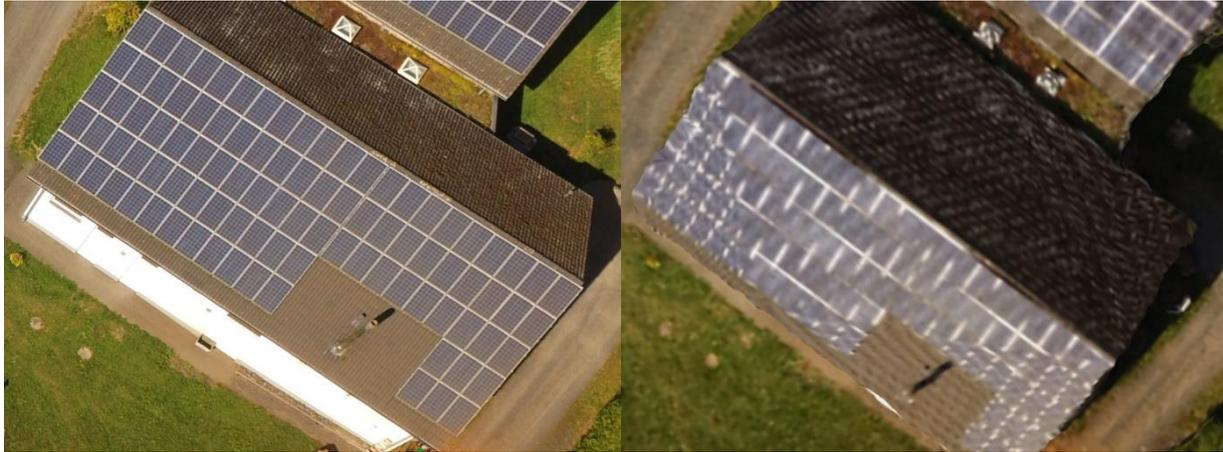
**Abbildung 14: Vergleich 3D-Modell mit Originalbild bei U1 (Links Ausschnitt aus Originalbild, Rechts 3D-Modell Export aus Metashape Standardprojekt)**
