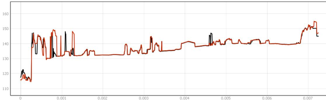
**Abbildung 30: Höhenprofil von DSM aus U1 bei Pix4Dmapper (rot = optimale Konfiguration, schwarz = Standardkonfiguration)**
