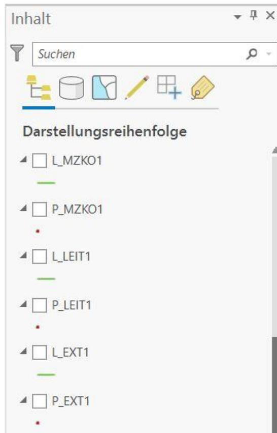
**Abbildung 20:** Hinzugefügte thematische Gliederungen als Punk- und Linien-Features im „ArcGIS Pro“ Projekt
