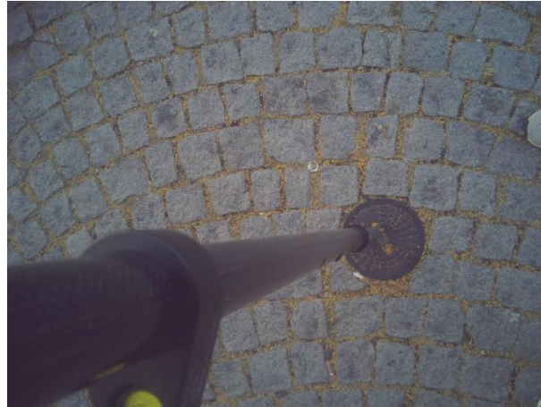
Abb. 42: Objekterfassung mit Lotstock (eigene Darstellung)
