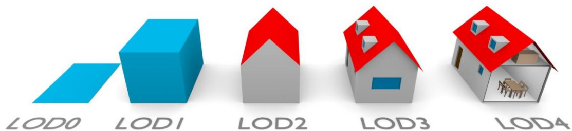
Abbildung 2: Die fünf LODs von CityGML 2.0 mit LOD4, das auch Innenräume modelliert [3]
