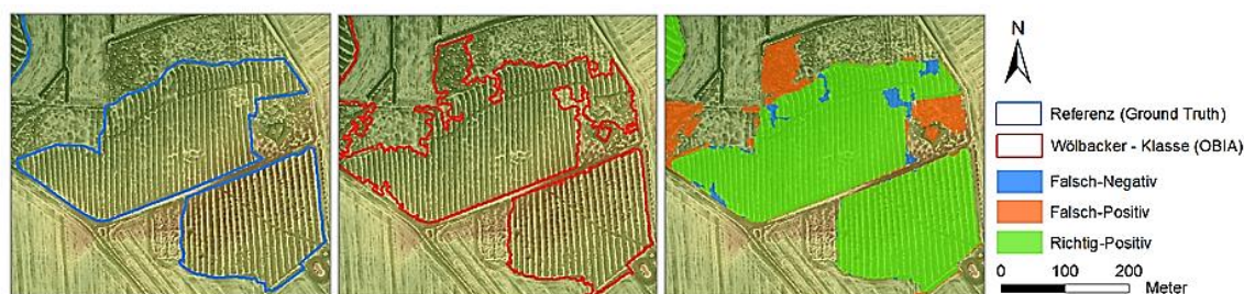
Abbildung 4.2: Manuell erstellte Umrise der Bodenreferenz für Wölbacker (li.), Wölbacker-Klassifizierung der OBIA (mi.) und deren Überlagerung (re.)
