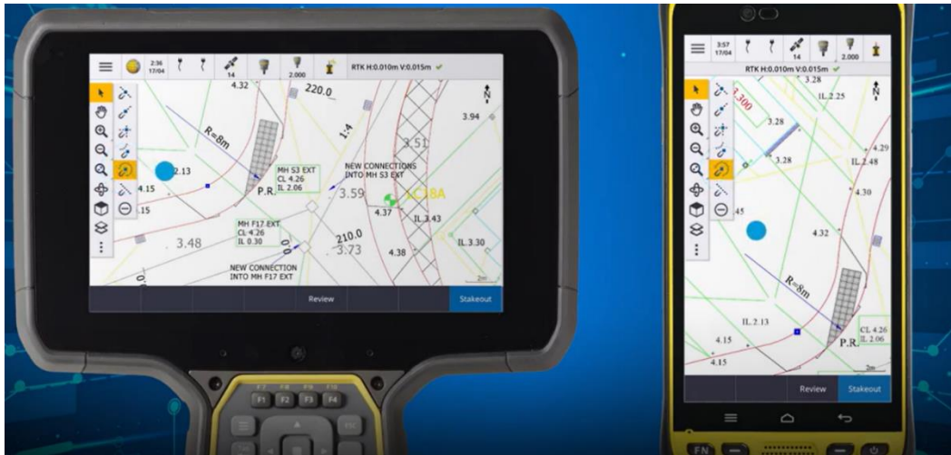
Abbildung 10: Verbindung neu aufgenommener mit bestehenden Daten über mit einer Totalstation verbundenen Controller-Hard- und Software (TRIMBLE 2021).
