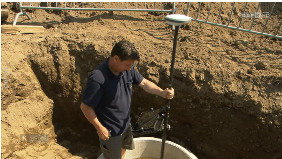
Abbildung 13: Einmessung eines Kanalschachts mittels GNSS-Vermessung (GISQUADRAT GMBH 2021a).
