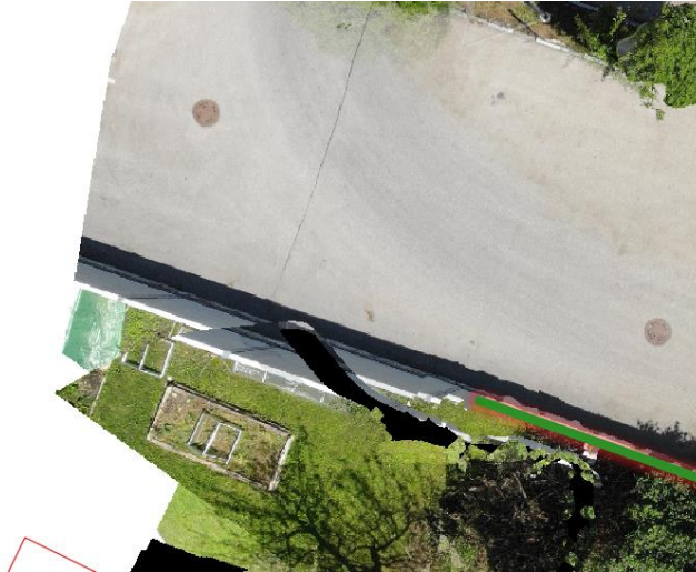
Abbildung 28: Starke Verzerrung am äußersten Rand des Untersuchungsgebietes, ein gängiges Phänomen (eigene Darstellung).
