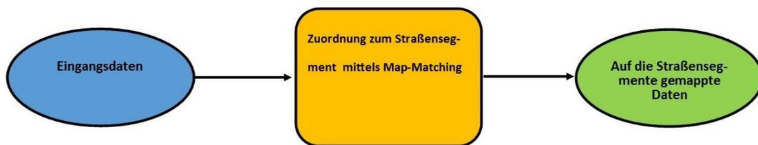
Abb. 20 Vorgehen zum Mapping der Eingangsdaten
