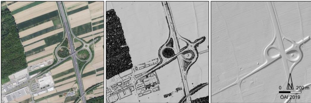
Abb. 4. Leibnitz. Autobahnanschluss Gralla. Orthofoto (links), DOM (Mitte) und DGM (rechts) GIS Steiermark.
