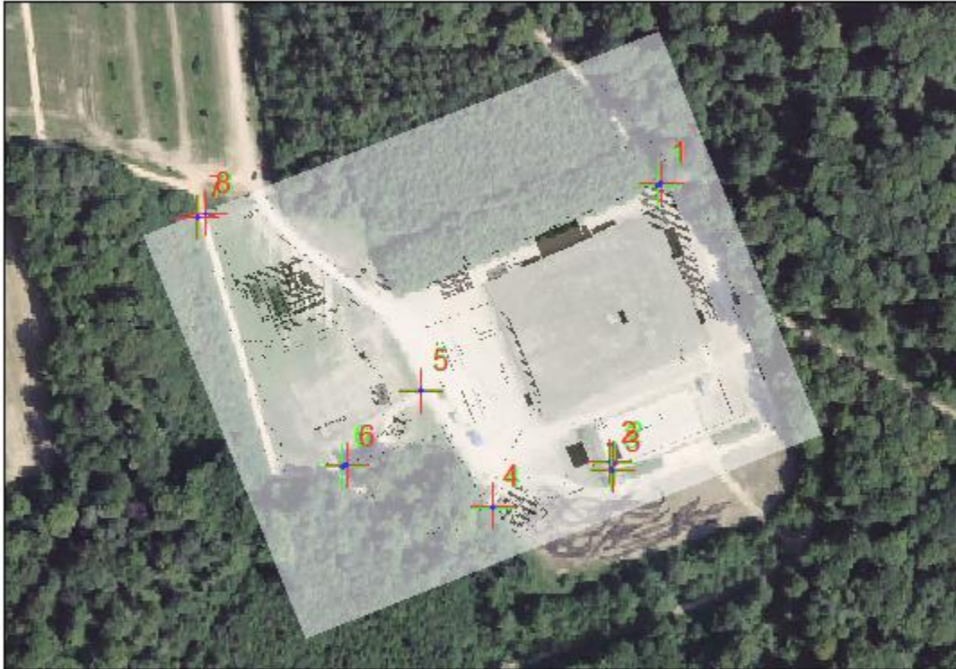
Abbildung 35: Fallbeispiel 2 - Georeferenzierung des Geländeplans über Referenzpunkte
