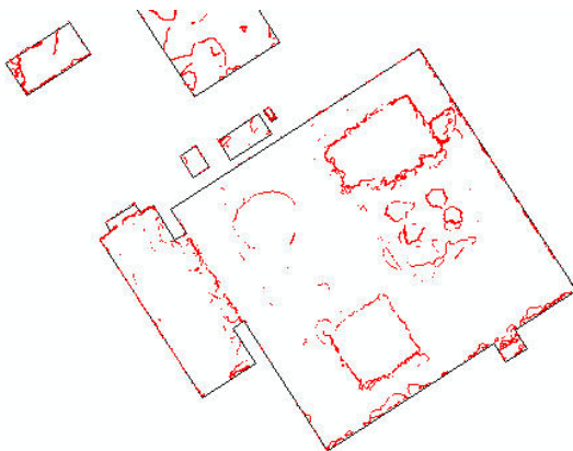
Abbildung 88: Generieren von Linien-Elementen auf Basis der Hangneigung mit dem Ergebnis von zu vielen Einzellinien
