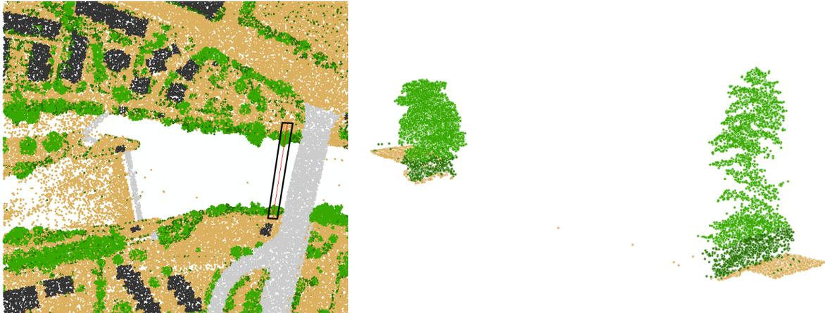
Abbildung 4 Gewässerbereich mit wenig LiDAR-Punkten. Mittels schwarzem Rechteck ist der Ausschnitt gekennzeichnet (im Bild links), welcher rechts Dreidimensional abgebildet ist.
