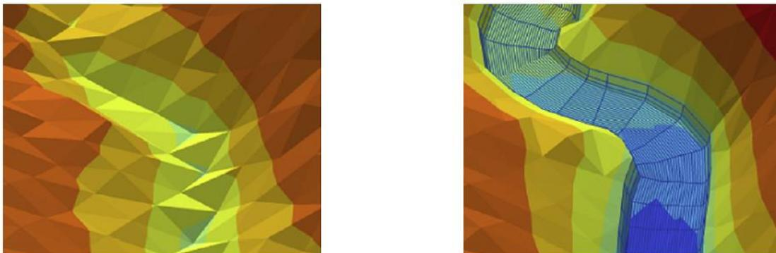
Abbildung 7 Gerinneintegration mittels Methode Merwade. (Abbildung aus Merwade 2009)
