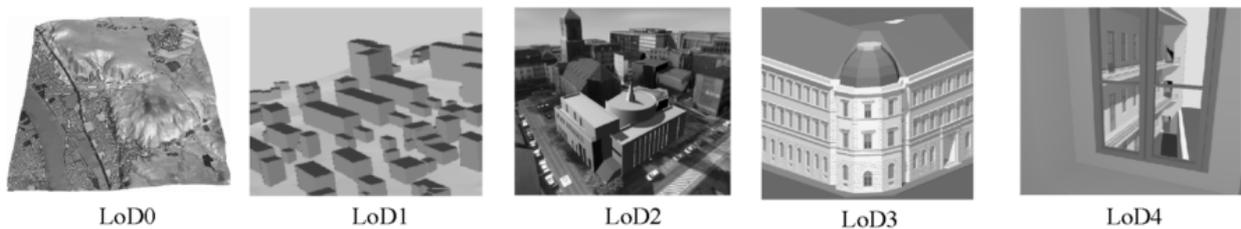
Abb. 12: Levels-of-Detail-Klassen nach KOLBE ET AL. (2009)
