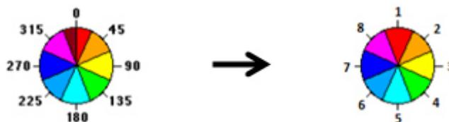
**Abb. 37:** Klassenbereiche der Ausrichtung vor der Reklassifizierung (= mit Nord-Teilung, links) sowie nach Zusammenführung des Nord-Segments (rechts)
