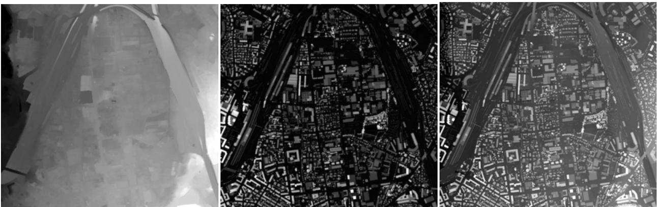
**Abb. 29:** Digitales Gelände Modell (DGM), normalisiertes Digitales Oberflächenmodell (nDOM) und Digitales Oberflächen Modell (DOM)
