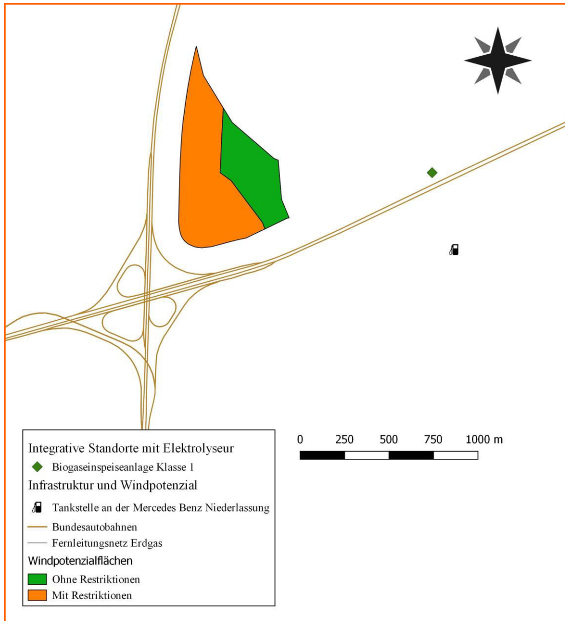
Abbildung 24: Exemplarische Darstellung einer integrativen Biogaseinspeiseanlage, die gleichzeitig neben der Wasserstoffeinspeisung auch eine Tankstelle mit Wasserstoff versorgen kann, eigene Darstellung
