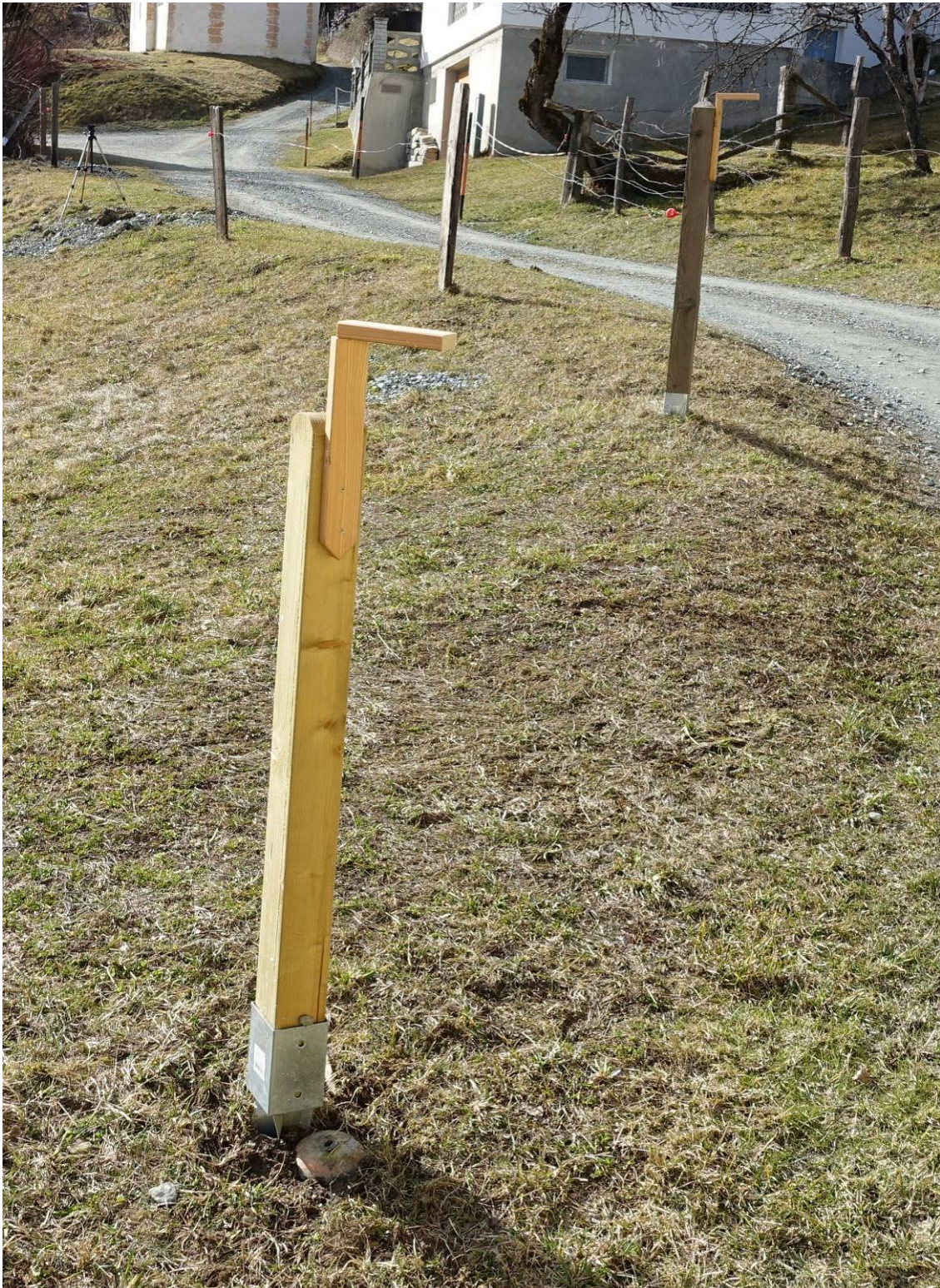
Abbildung 9: Vermessungspunkt mit Zaunpfahl und Auflagevorrichtung. Foto: C. Keusch 2017. Um zu gewährleisten, dass während des Messvorgangs möglichst viele GNSS-Satelliten zur Verfügung standen, wurde im Vorfeld die Anzahl der sichtbaren Satelliten eruiert. Dies erfolgte mit Hilfe der von www.trimble.com zur Verfügung gestellten Onlinevorschau der Satellitenabdeckung 13 (siehe Abbildung 10). Im
