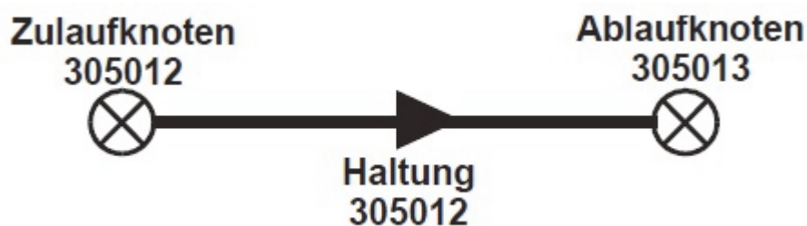
Abbildung 14: Beispiel Bezeichnung von Schächten und Haltungen (Bundesministerium für Umwelt, Naturschutz, Bau und Reaktorsicherheit 2014, S. 63)
