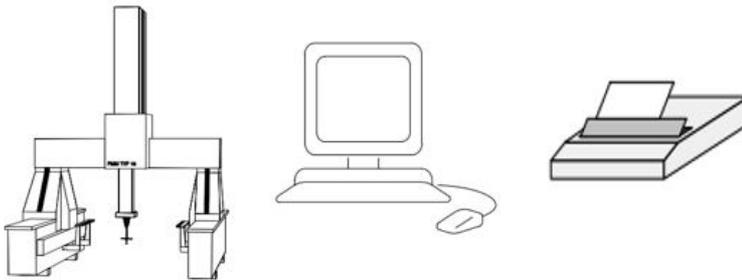
Abbildung 13 - 3D Koordinatenmessgerät, Terminalrechner, Ausgabegerät
