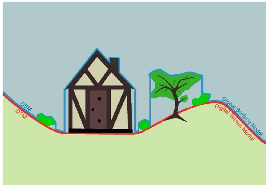
Abbildung 7 Unterschied zwischen DTM und DOM (Quelle: [www.ocad.com](http://www.ocad.com))
