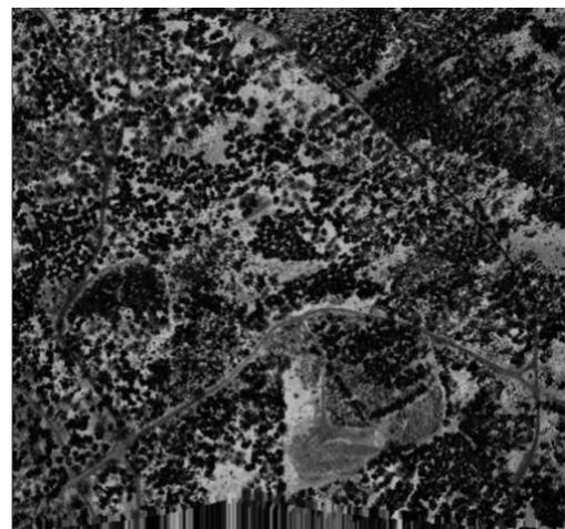
Abbildung 34 OL Laser: Intensitätskarte des Oberflächenmodells, Unterscheidung zwischen Laub- und Nadelwald
