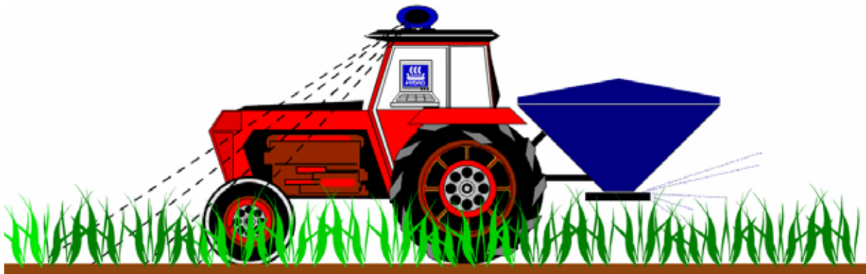
Abbildung 4: Terrestrischer, auf dem Traktordach montierter N-Sensor mit angeschlossenem Prozessrechner, welcher u. a. anhand der in Echtzeit gemessenen spektralen Signatur des Pflanzenbestandes das Ausbringen von Stickstoffdünger steuert. Quelle: YARA (2005).
