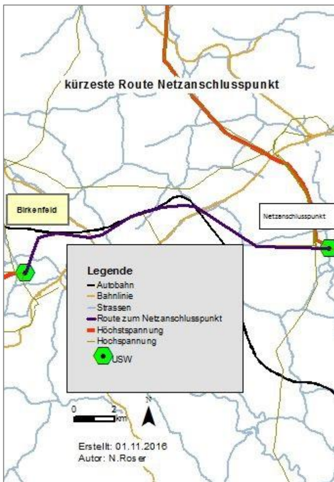
Abbildung 31: kürzeste Route Netzanschlusspunkt
