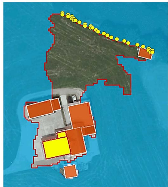
Abb. 55: Fehlerkategorie I Beispiel für Fall 1 und 2. Gebäude des ersten Fall (orange). Gebäude des zweiten Fall (gelbe Fläche), Untersuchungspunkte (gelbe Punkte) Überflutungsfläche (blau, transparent mit roter Kante)
