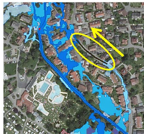
Abb. 27: Verzweigte Ausströmung, z.T. mit Rückfluss, sowie abrupten Unterbrechungen. Fließrichtung von Südost nach Nordwest (Quelle: ZEISLER 2011:8)
