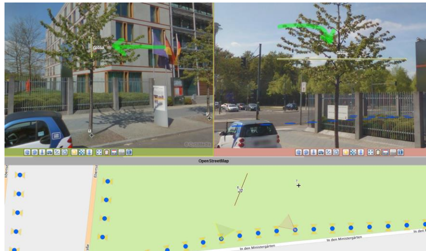
Abbildung 53. Ergebnisdarstellung (4,66m) der Messung des Kronendurchmessers (CycloMedia Technology B.V. (GlobeSpotter)).
