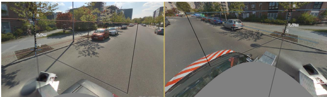
Abbildung 43. Ermittlung der Kronenansatzhöhe durch Stereobildauswertung (CycloMedia Technology B.V. (GlobeSpotter)).
