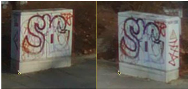
Abbildung 11. Homologe Bildpunkte des selben Objektteils auf zwei Aufnahmen (CycloMedia Technology B.V. (GlobeSpotter)).
