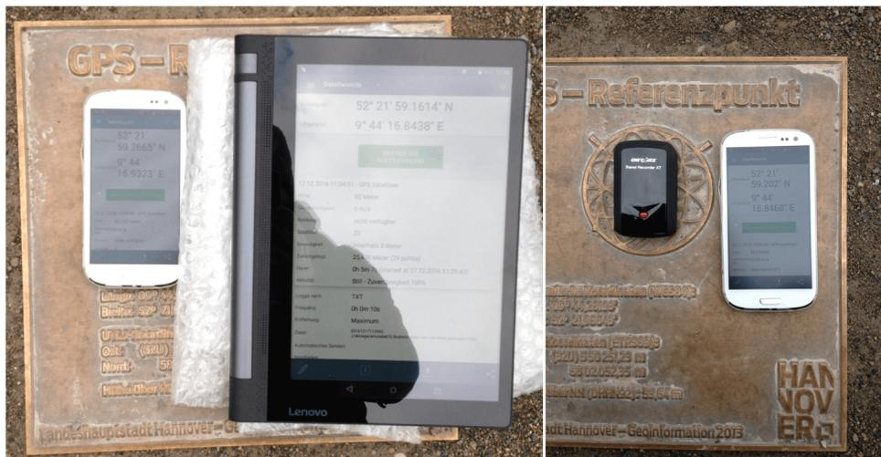
Abbildung 75: Messkonstellation während der GNSS-Referenzmessung am Referenzpunkt
