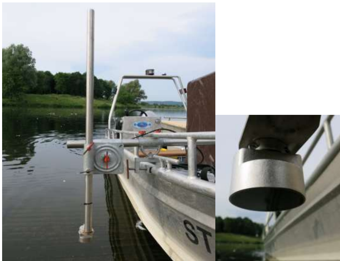
Abb. 2.9 links montierter Transducer am Messboot, rechts Detail vom Transducer
