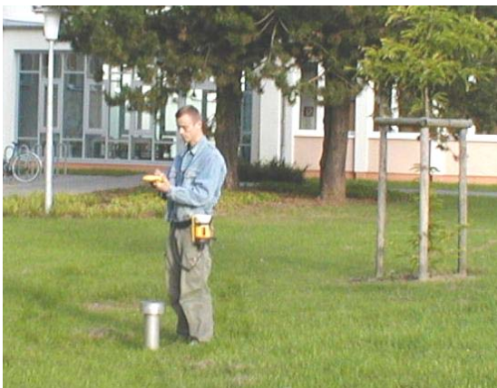
Abbildung 5-4 Testmessungen zur Untersuchung der Verfügbarkeit von DGNSS-Beacon mit dem Trimble BoB (Quelle: Autor)
